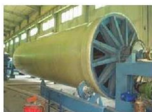
Изготовление внутреннего слоя
